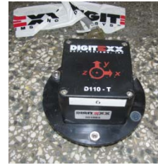
Сл. 5. Триаксијален сензор Digitexx D110-T
